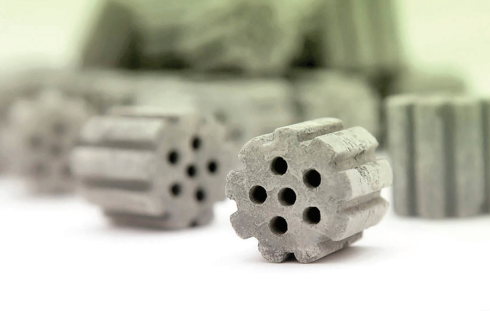
کاتالیست فعال آهن اسفنجی فرایند میدرکس
