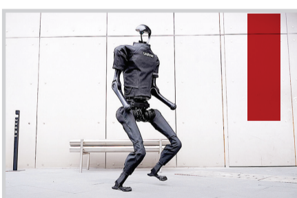
پانچ درجه و بازوها چهار درجه آزادی دارند و انگشتی برای آن طراحی نشده بلکه نوک بالشتک ماندندی در انتهای بازوها تعبیه شده است.
