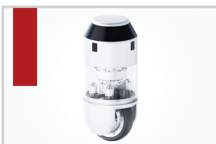
داری ماژول PdD از اجزای می‌دهد تا به طور مستقل حرکت کند. این ماژول‌ها را می‌توان به هر چیزی از میز گرفته تا ظروف برای حرکت بیشتر متصل کرد.
